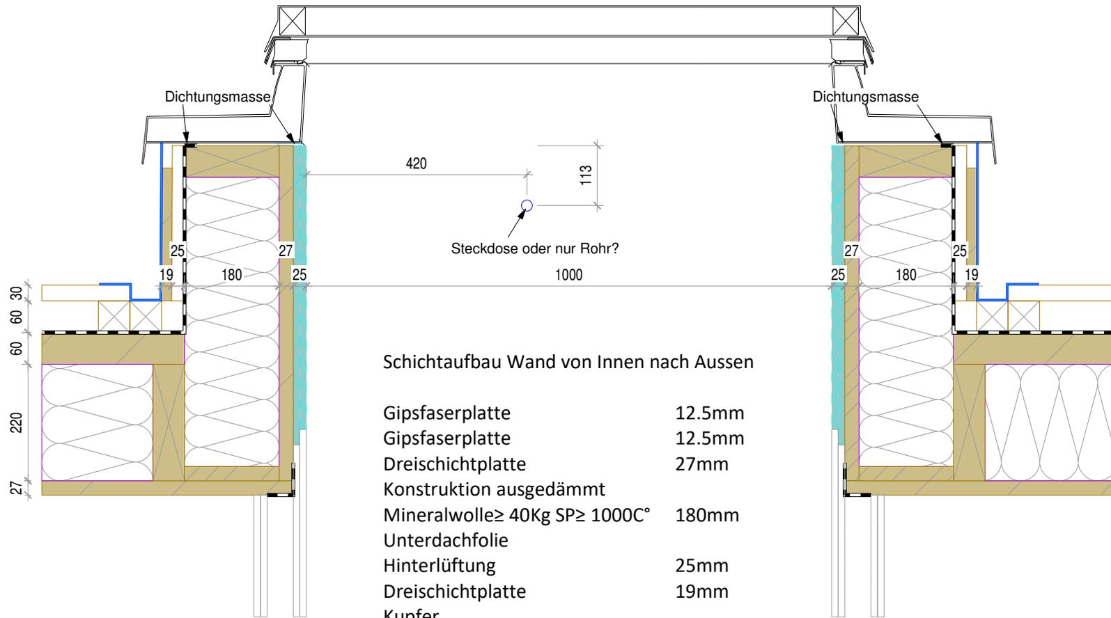
Schichtaufbau Wand von Innen nach Aussen
